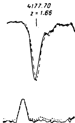
Фиг. 9. Микрофотометрическая запись линии \lambda 4177 \text{ \AA} в спектре звезды 78 Девы. Пластика пропусклась через микрофотометр 4 раза без изменения установки (не считая передвижения пластинки под прямым углом к направлению дисперсии). Виден относительный сдвиг между линиями в двух спектрах звезды, имеющих взаимно-противоположную поляризацию, тогда как линии в спектрах сравнения (нижняя кривая) по обе стороны звёздных спектров совпадают. Для того чтобы можно было отличить кривые, принадлежащие разным спектрам, на пути пишущего луча ставился обтюратор, в результате чего получалась запись прерывистой линией [4].
